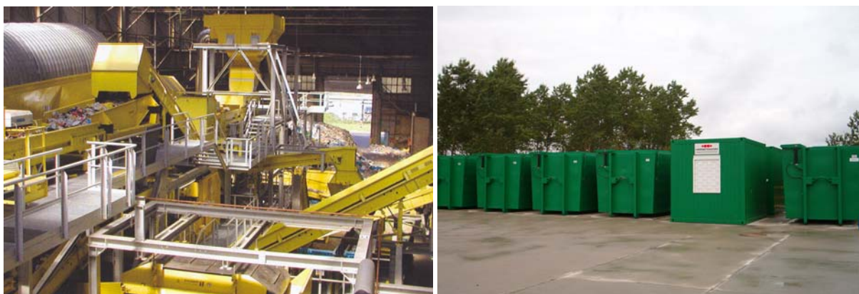
Rys.2: Kompleks sortowni (po lewej) i kompostownia kontenerowa typu KNEER (po prawej)
