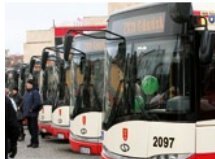
Wszystkie Solarisy są niskopodłogowe, co ułatwia podróż osobom niepełnosprawnym.
