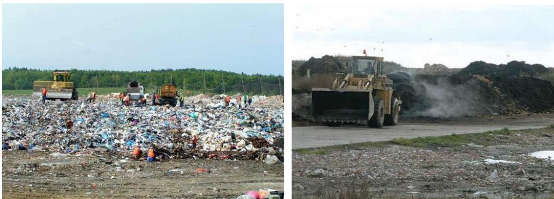
Rys.5: Prace sprzętu ciężkiego (po lewej – prace na kwaterze składowej; po prawej – praca przetrzucarki na placu kompostowym).
