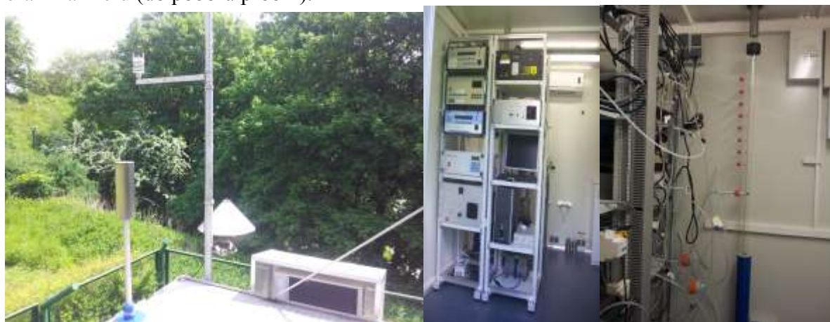
Stacja pogodowa Vaisala WXT 520 oraz Mainfold na stacji AM1 Gdańsk Śródmieście
