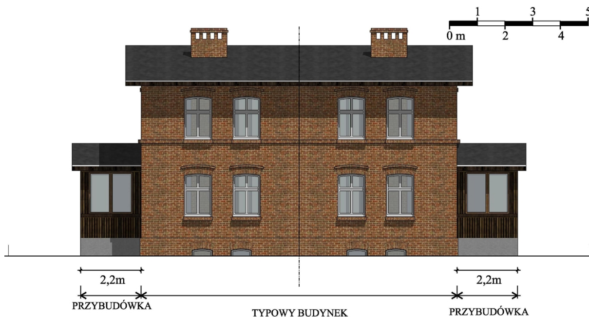
ELEWACJA OGRODOWA TYPOWEGO BUDYNKU Z PRZYBUDÓWKAMI
