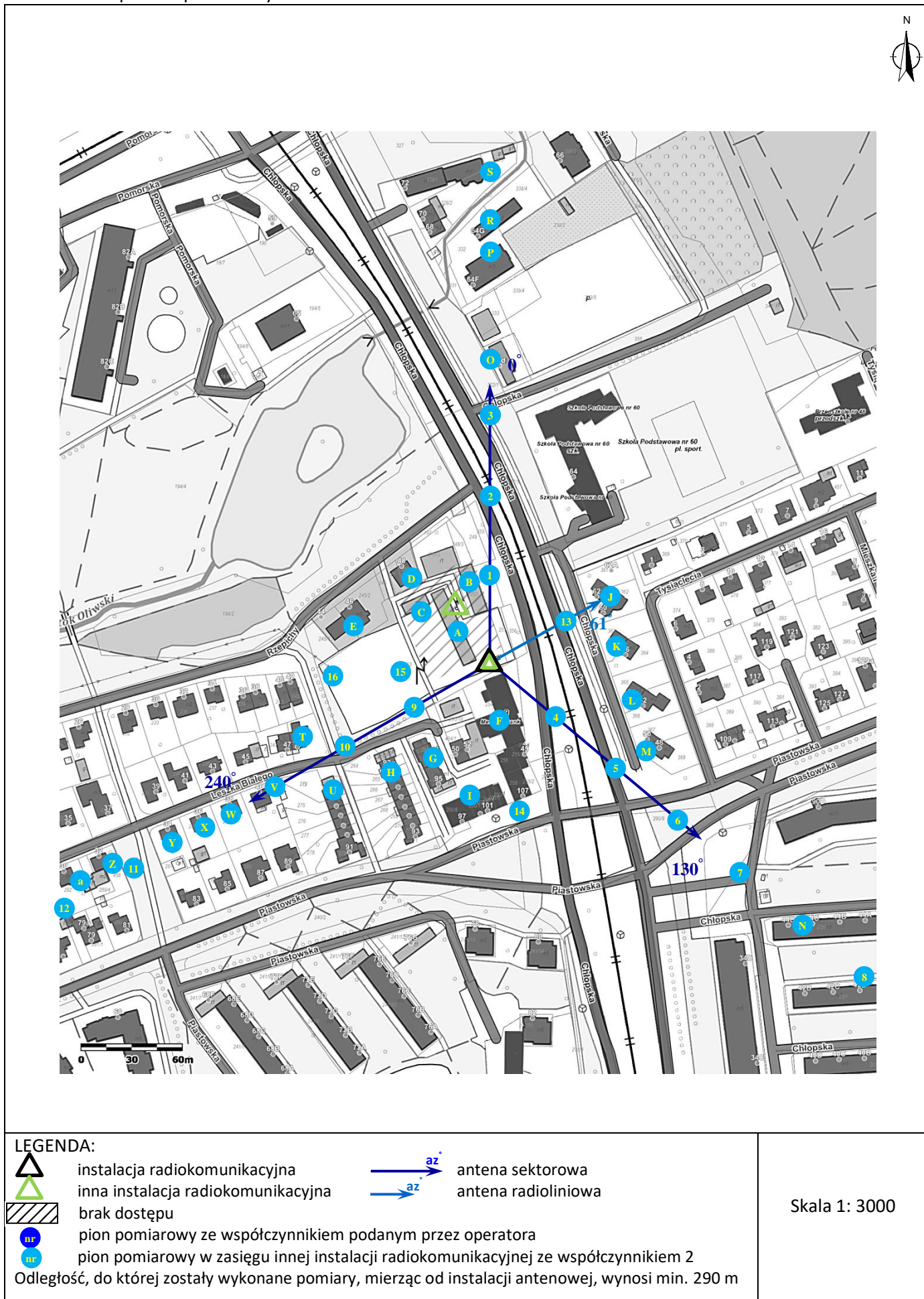
Załącznik 2. Widok pionów pomiarowych
