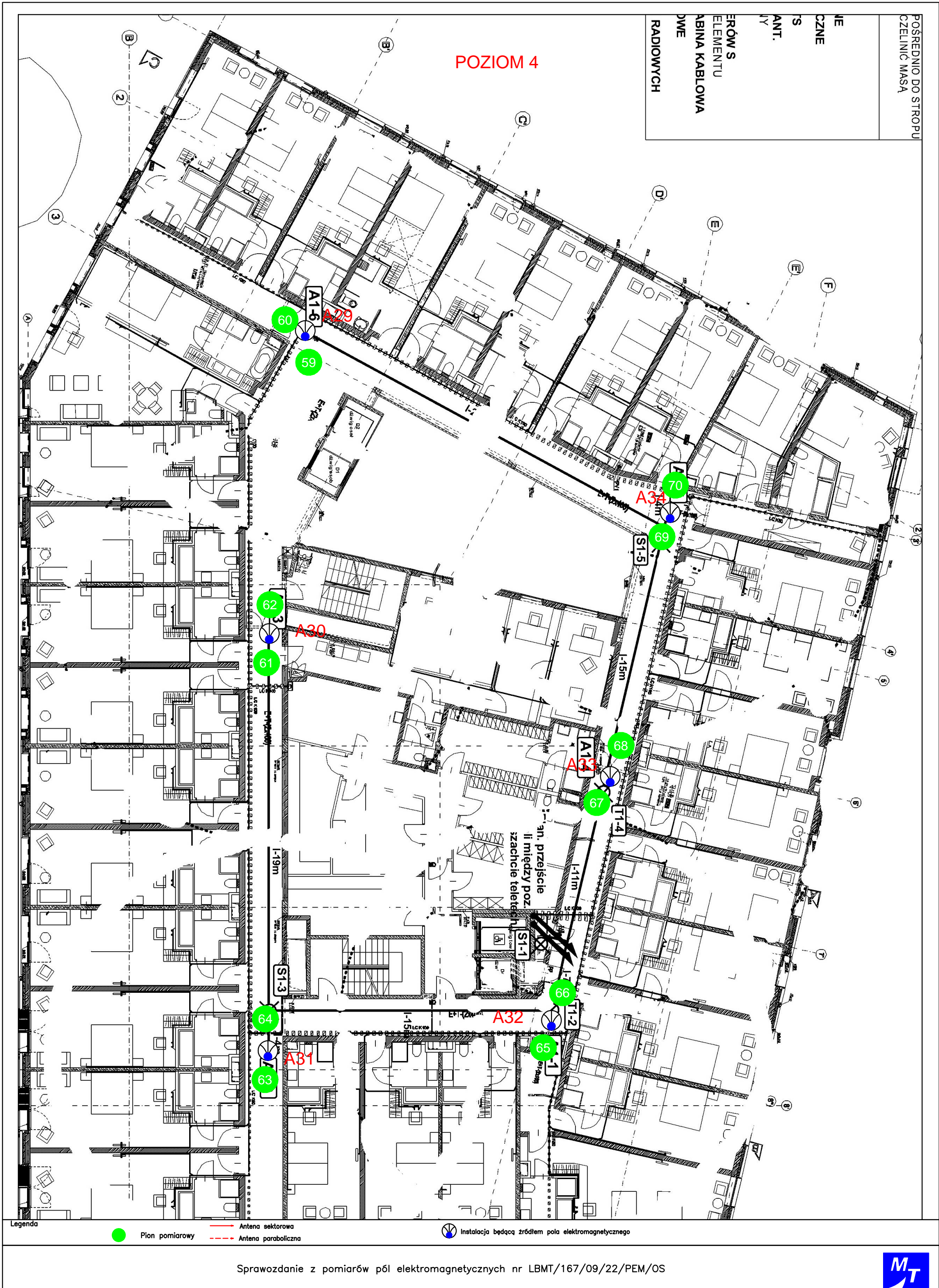
Rys.6 Lokalizacja pionów pomiarowych
