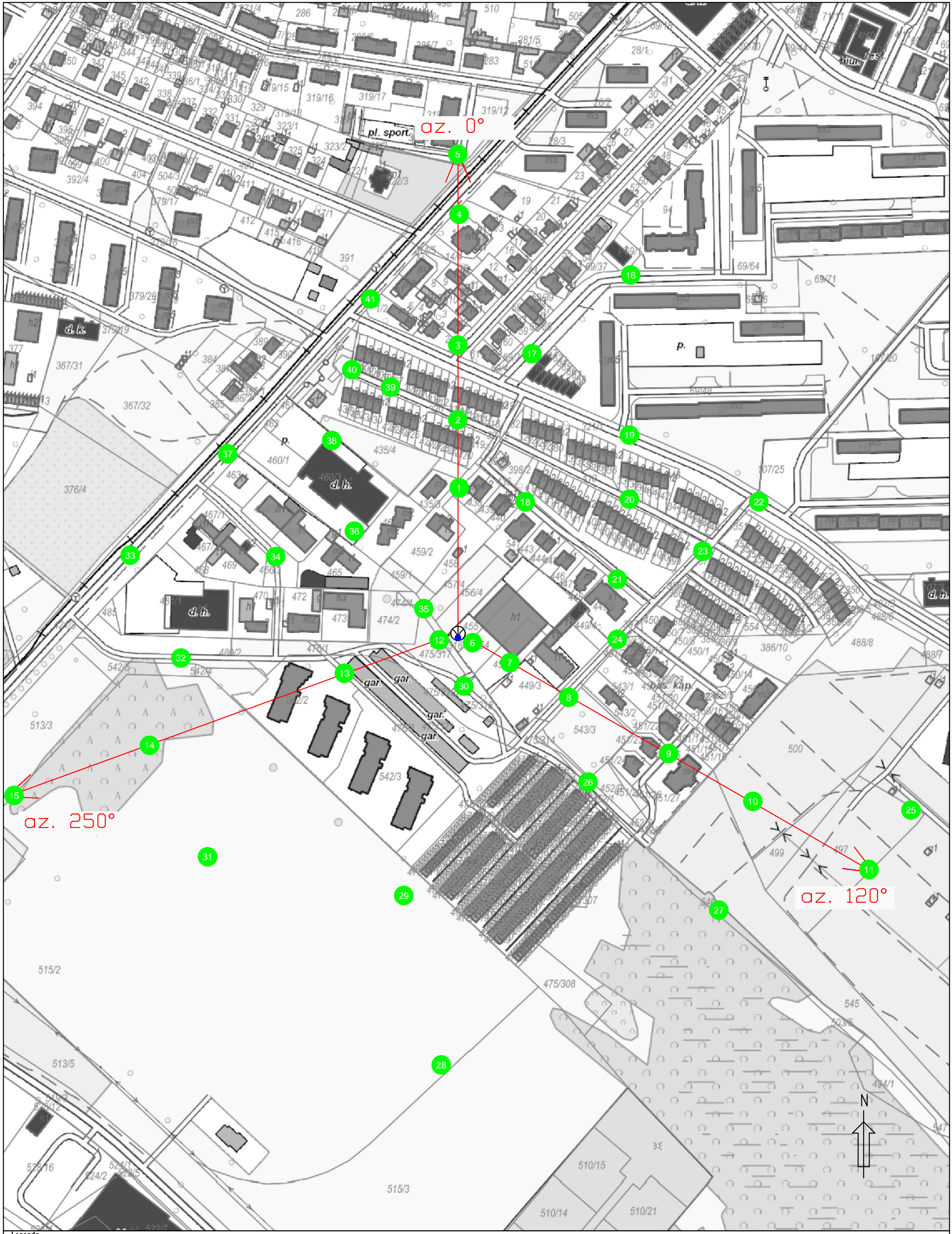
Rys.1 Lokalizacja pionów pomiarowych
