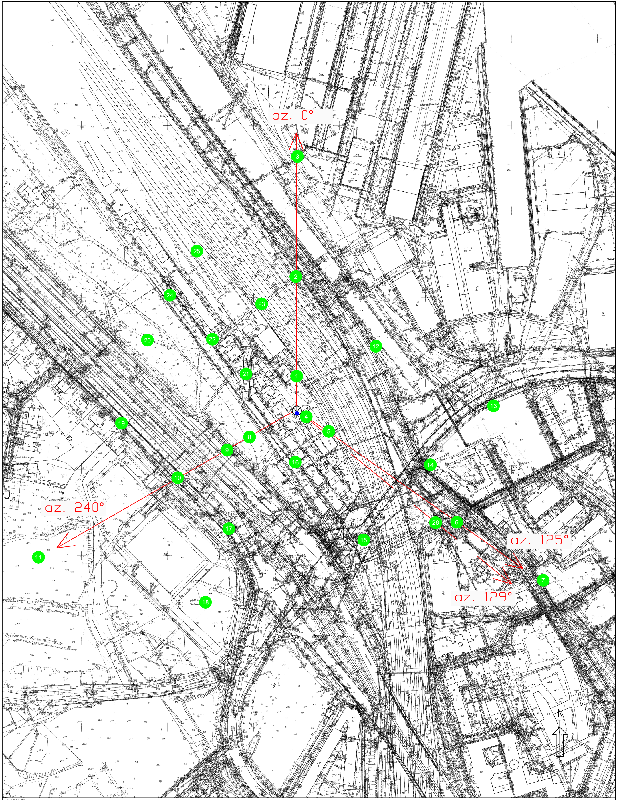
Rys.1 Lokalizacja pionów pomiarowych
