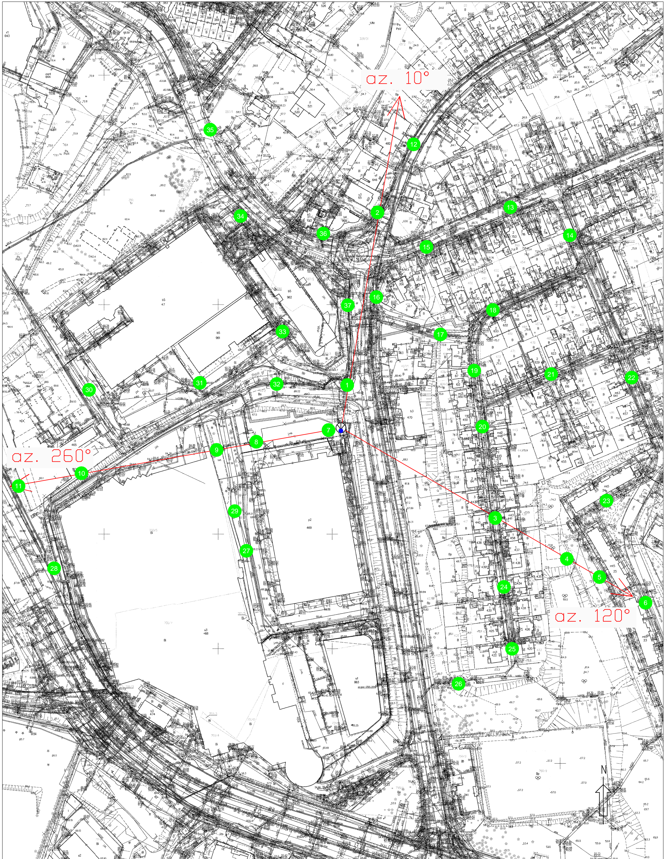
Rys.1 Lokalizacja pionów pomiarowych
