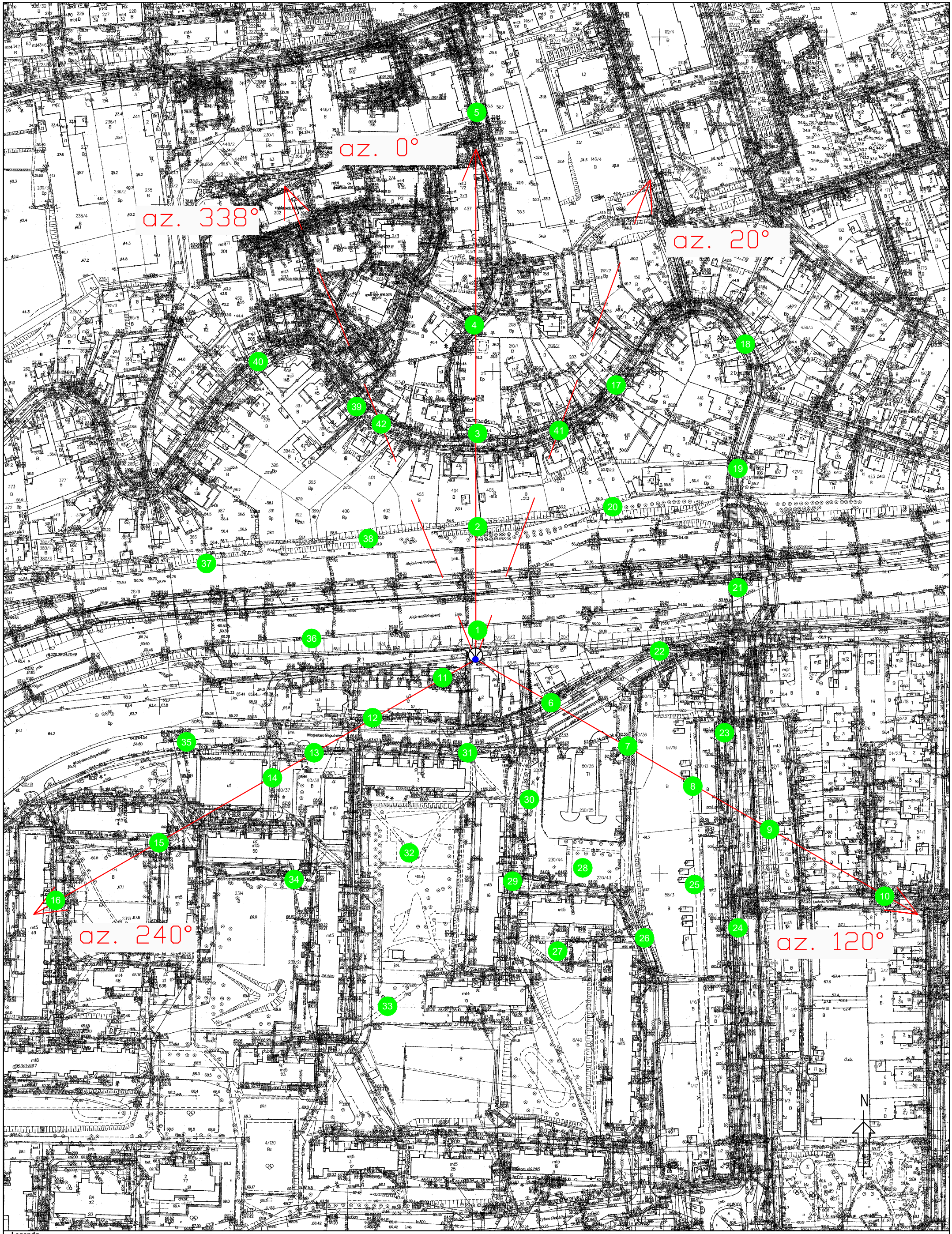
Rys.1 Lokalizacja pionów pomiarowych
