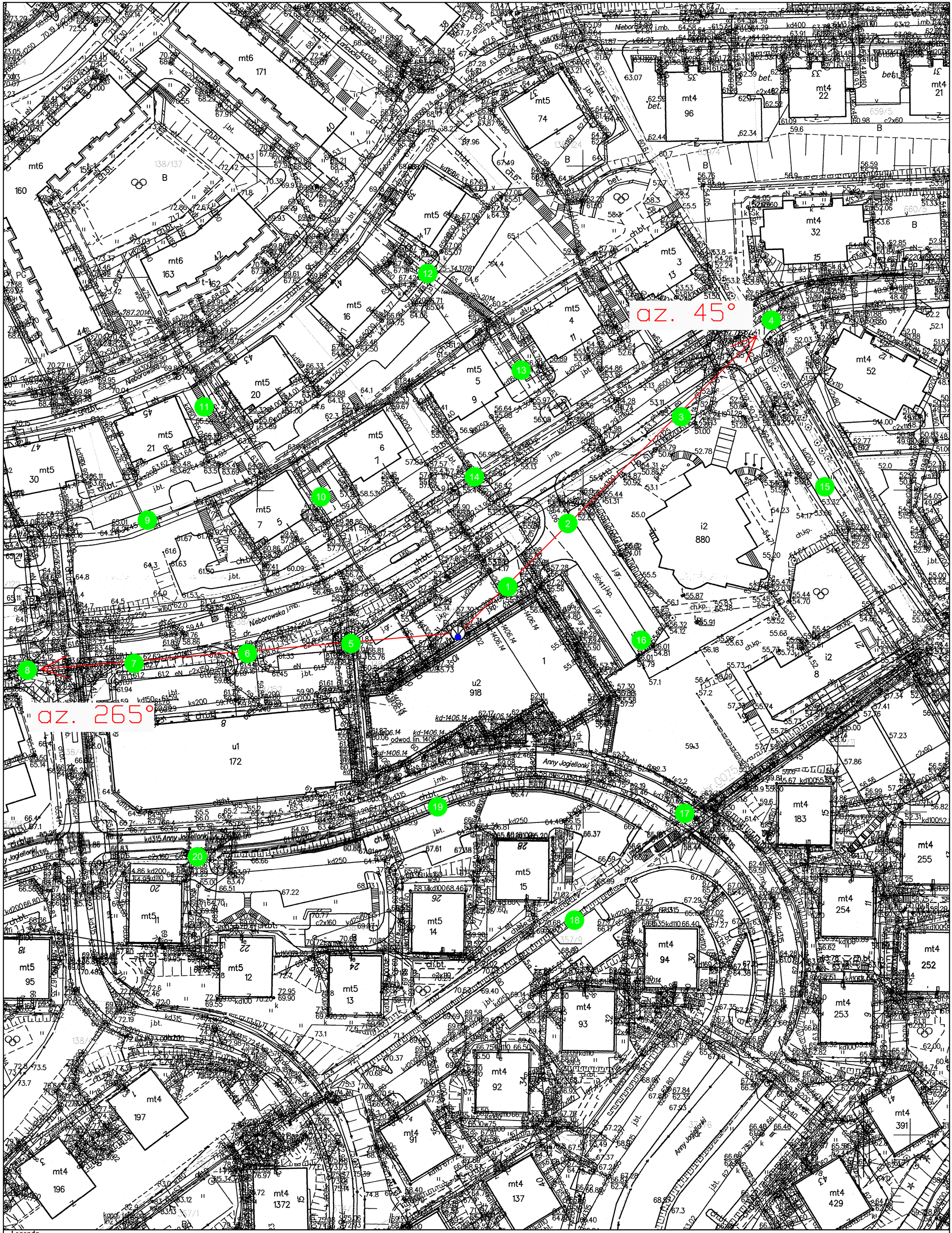
Rys.1 Lokalizacja pionów pomiarowych
