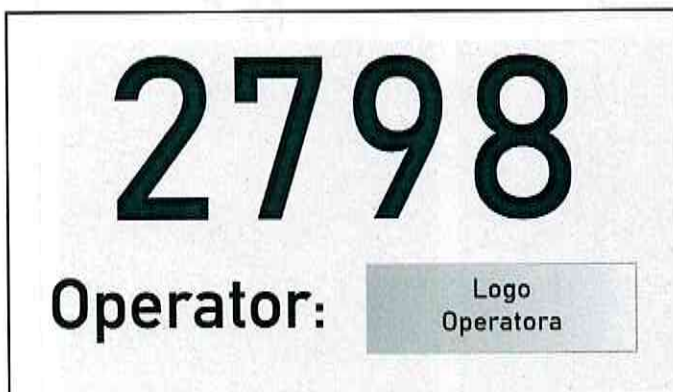
Rys. 4.2. Numer ewidencyjny wraz z logo Operatora - na tylnej ścianie kabiny prowadzącego pojazd, wewnątrz pojazdu
