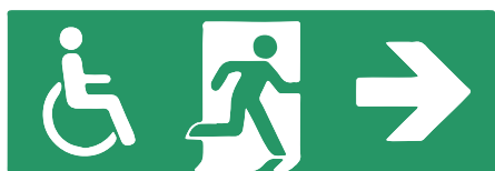
Ryc. 5.1. Symbol dostępnej drogi ewakuacyjnej (źródło ISO/FDIS 21542:2011)
