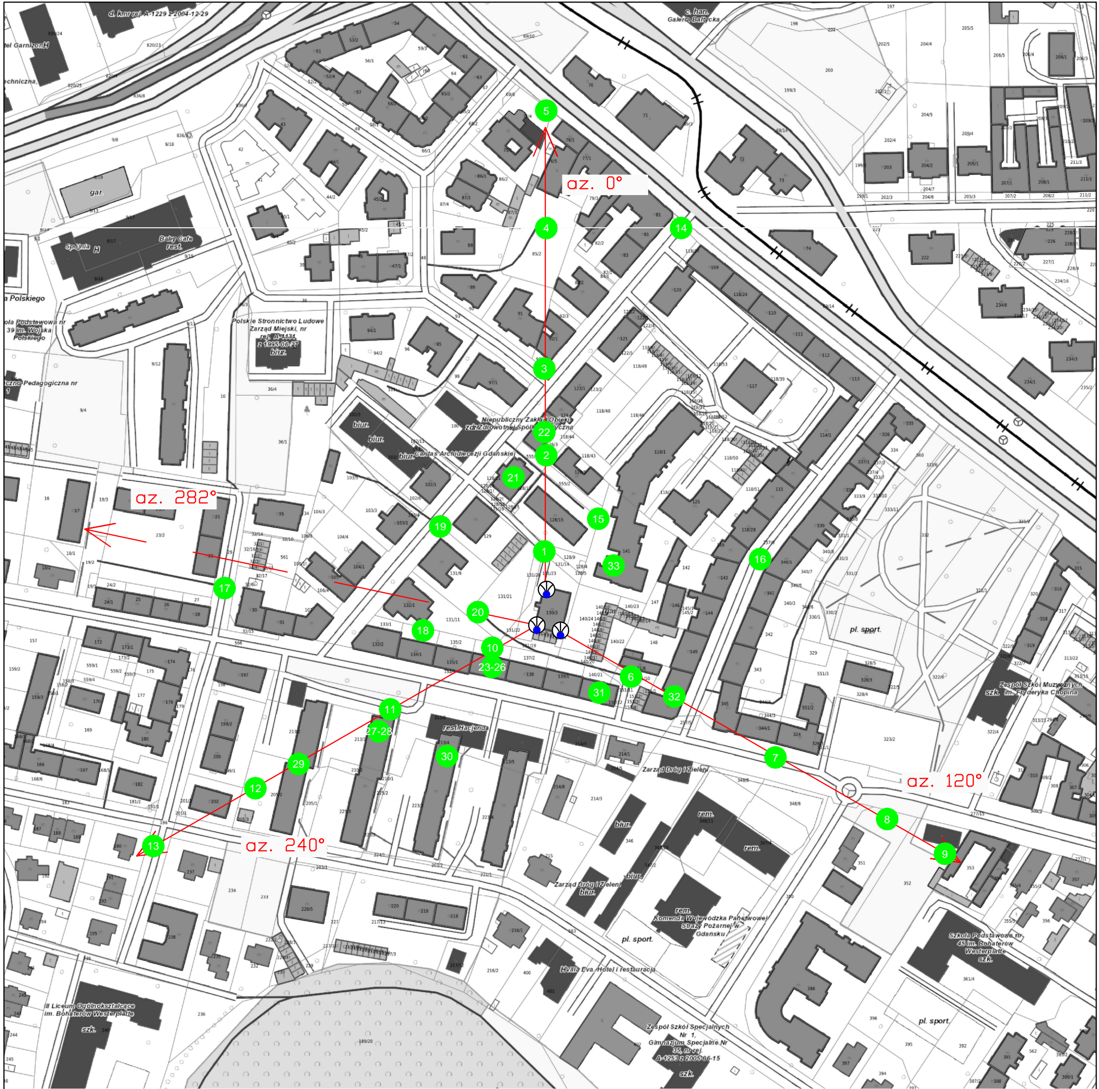
Rys.1 Lokalizacja pionów pomiarowych
