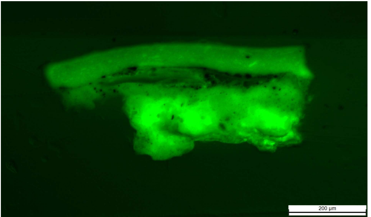
Fotografia luminescencji przekroju poprzecznego próbki P2.2 wzbudzonej promieniowaniem UV. Liczbami oznaczono kolejne warstwy.
