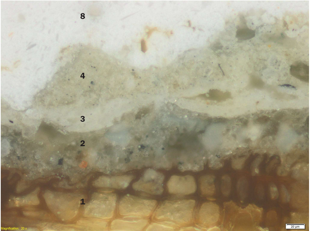
Fotografia przekroju poprzecznego próbki P2.1, powiększenie x200. Liczbami oznaczono kolejne warstwy.
