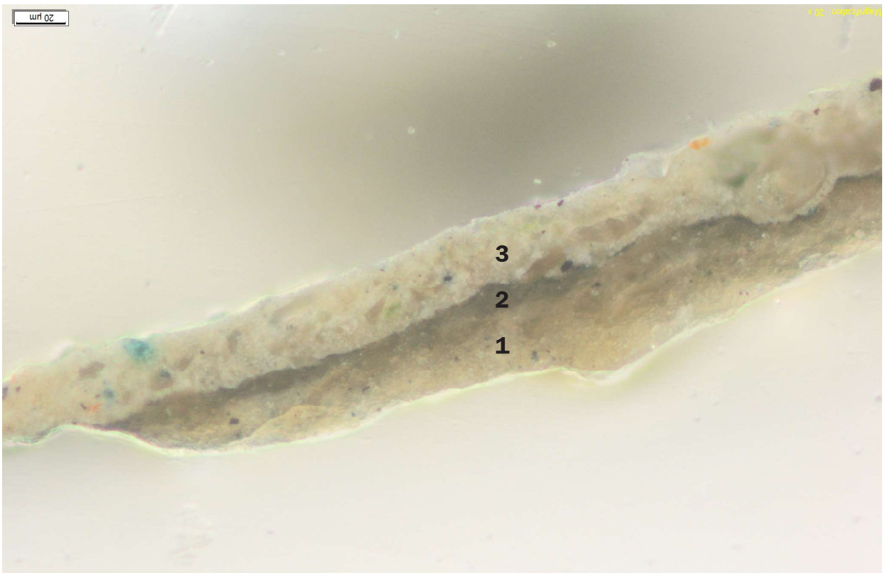
Fotografia przekroju poprzecznego próbki P8.1, powiększenie x200. Liczbami oznaczono kolejne warstwy.
