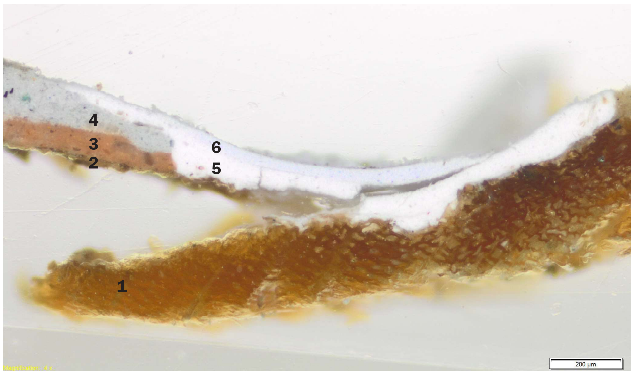
Fotografia przekroju poprzecznego próbki, powiększenie x40. Liczbami oznaczono kolejne warstwy.
