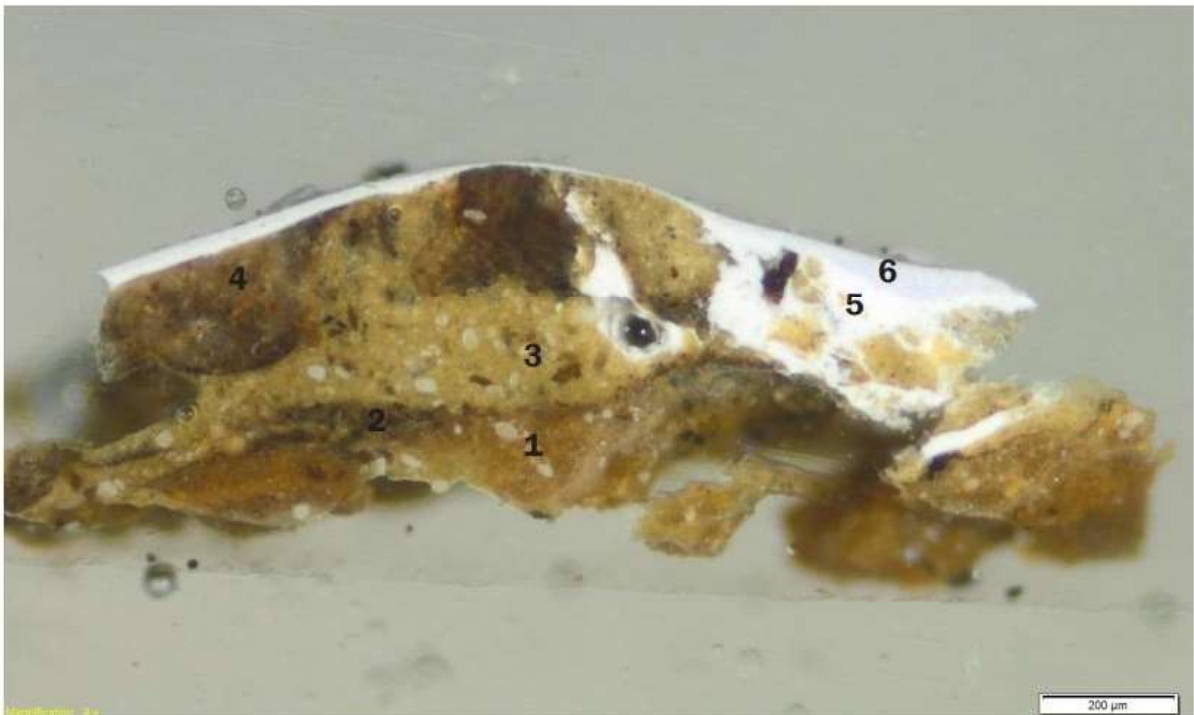
Fotografia przekroju poprzecznego próbki, powiększenie x40. Liczbami oznaczono kolejne warstwy.
