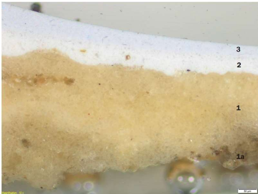
Fotografia przekroju poprzecznego próbki, powiększenie x100. Liczbami oznaczono kolejne warstwy.
