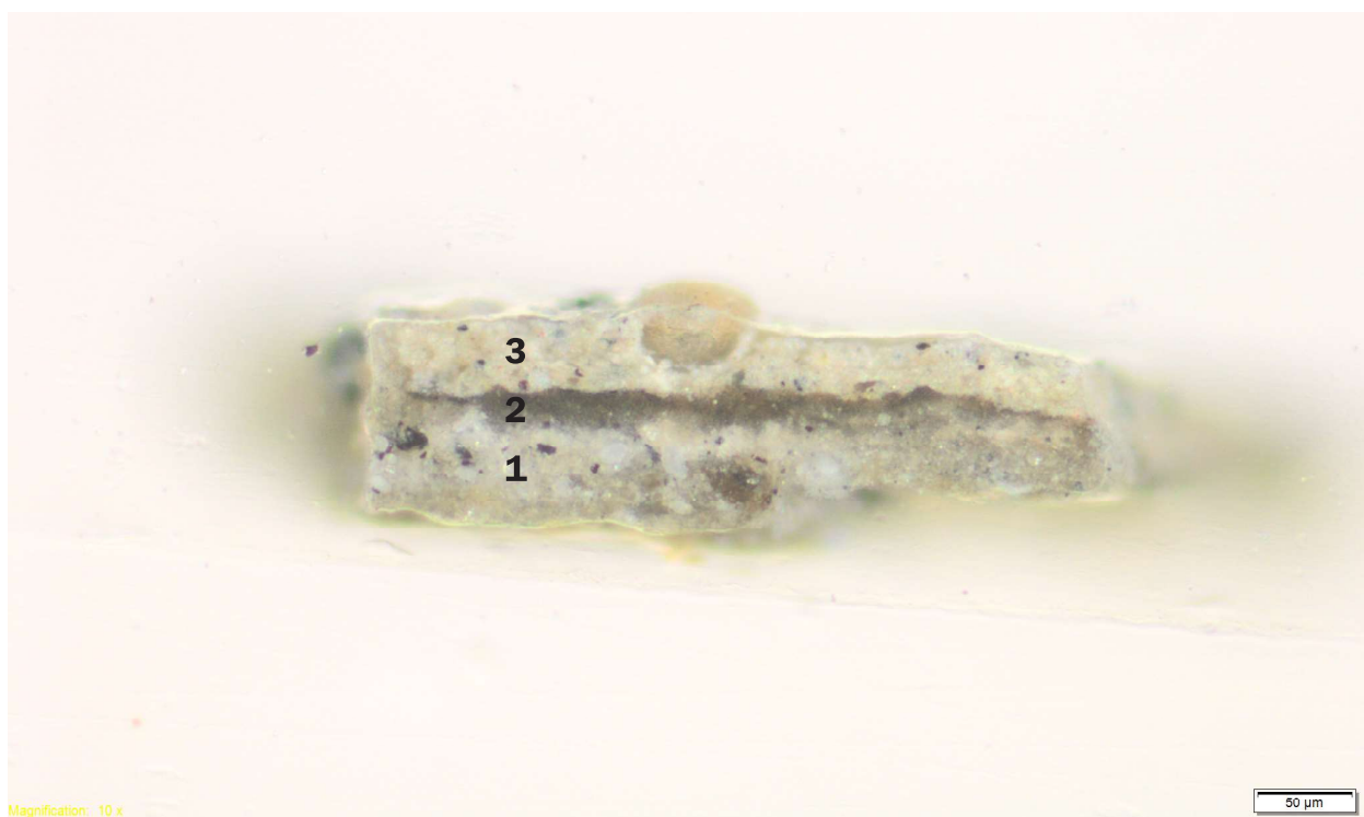
Fotografia przekroju poprzecznego próbki P8.2, powiększenie x100. Liczbami oznaczono kolejne warstwy.
