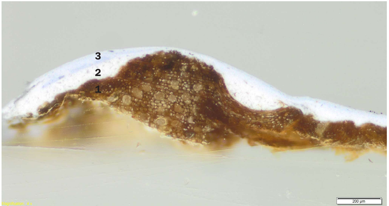
Fotografia przekroju poprzecznego próbki, powiększenie x40. Liczbami oznaczono kolejne warstwy.
