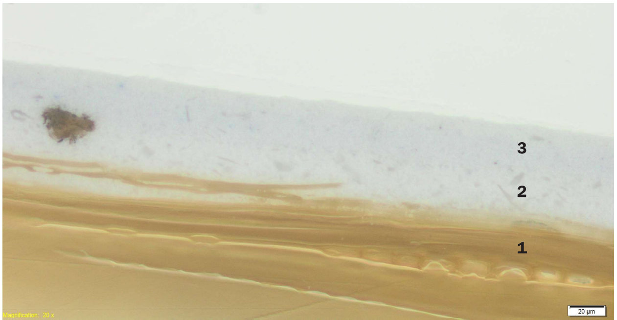
Fotografia przekroju poprzecznego próbki, powiększenie x200. Liczbami oznaczono kolejne warstwy.
