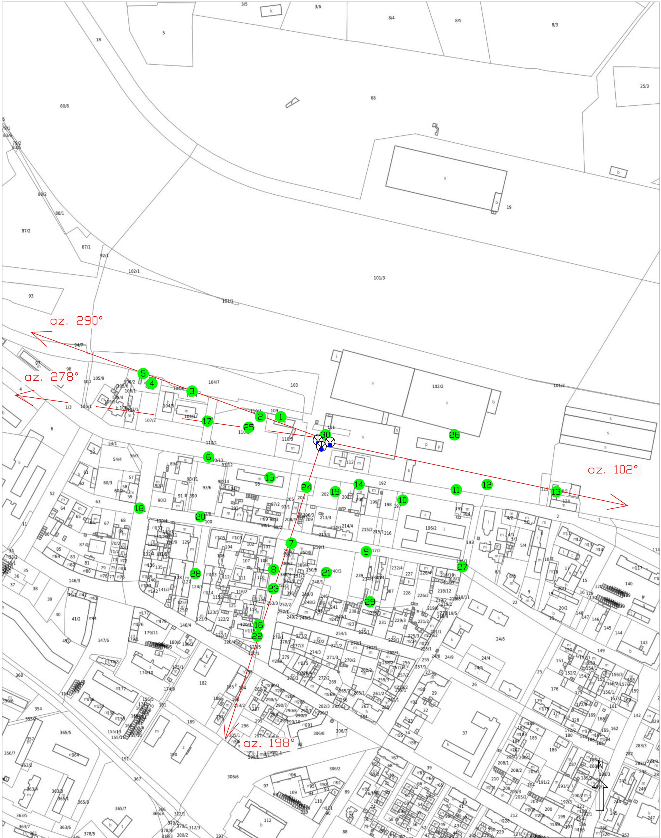
Rys.1 Lokalizacja pionów pomiarowych
