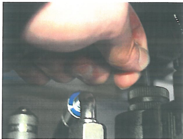
Rysunek 4 ręczne opuszczanie siłownika hydraulicznego
