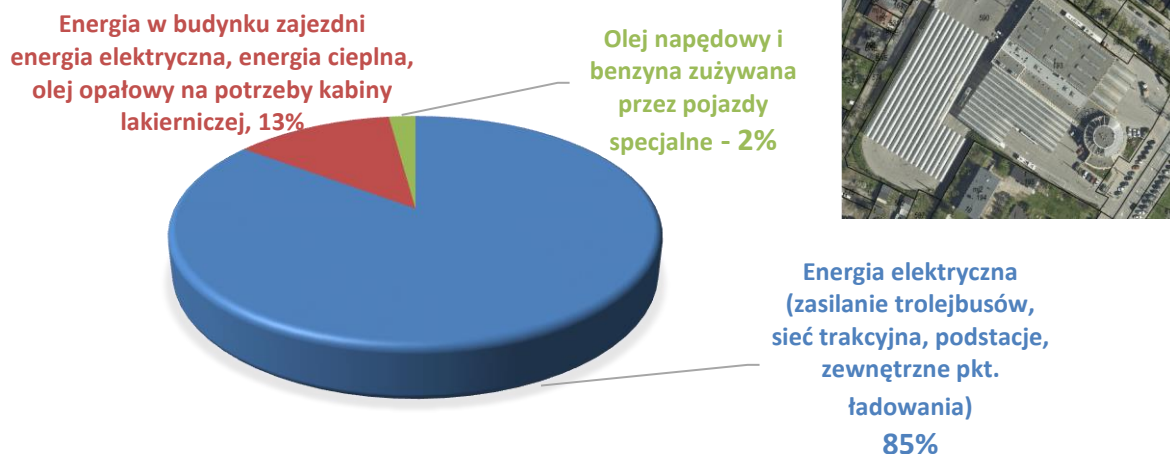
Rys. 3. Fotografia zajezdni PKT oraz struktura użytkowania energii, w tym paliw. Źródło: Woronowicz [2]
