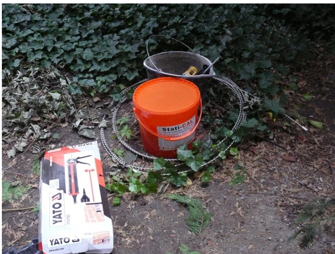
System dedykowany do zsiwiania murów- Stati- Cal, zaprawa i pręty o zwoju śrubowym ze stali nierdzewnej.
