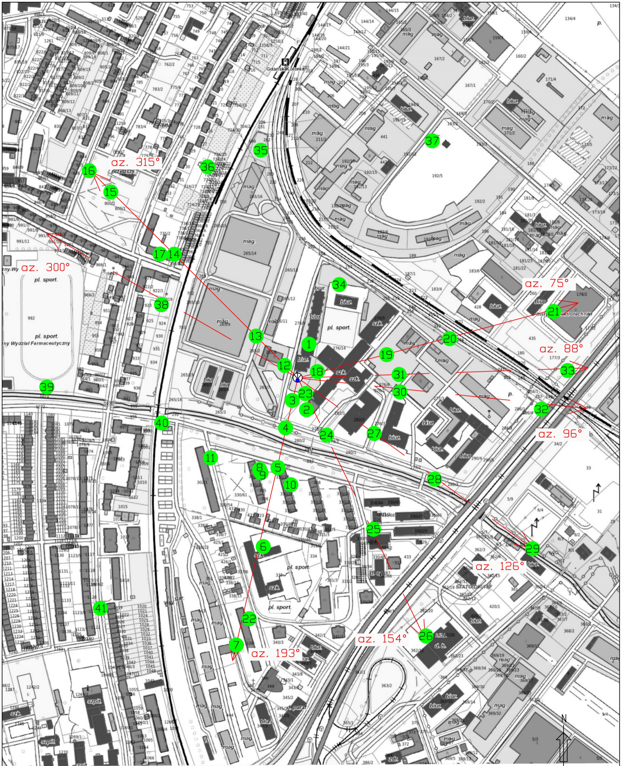
Rys.1 Lokalizacja pionów pomiarowych
