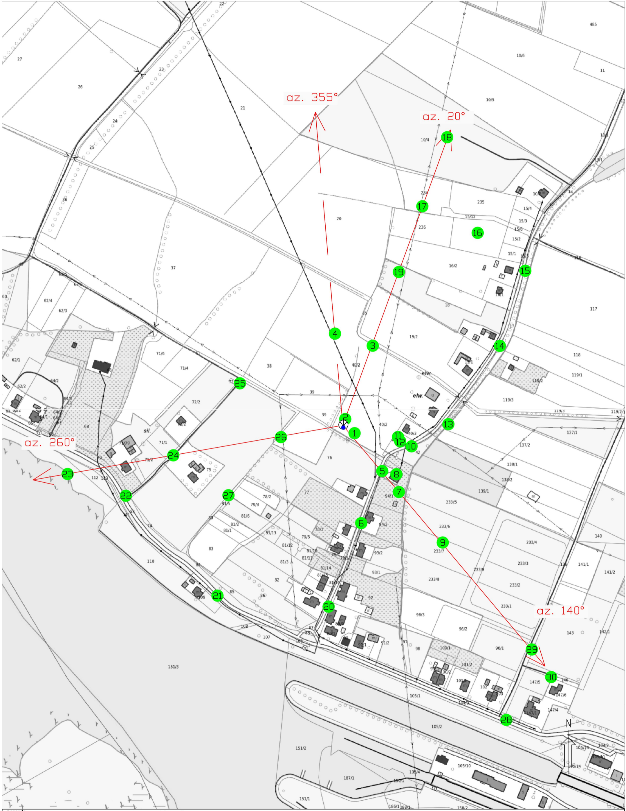
Rys.1 Lokalizacja pionów pomiarowych
