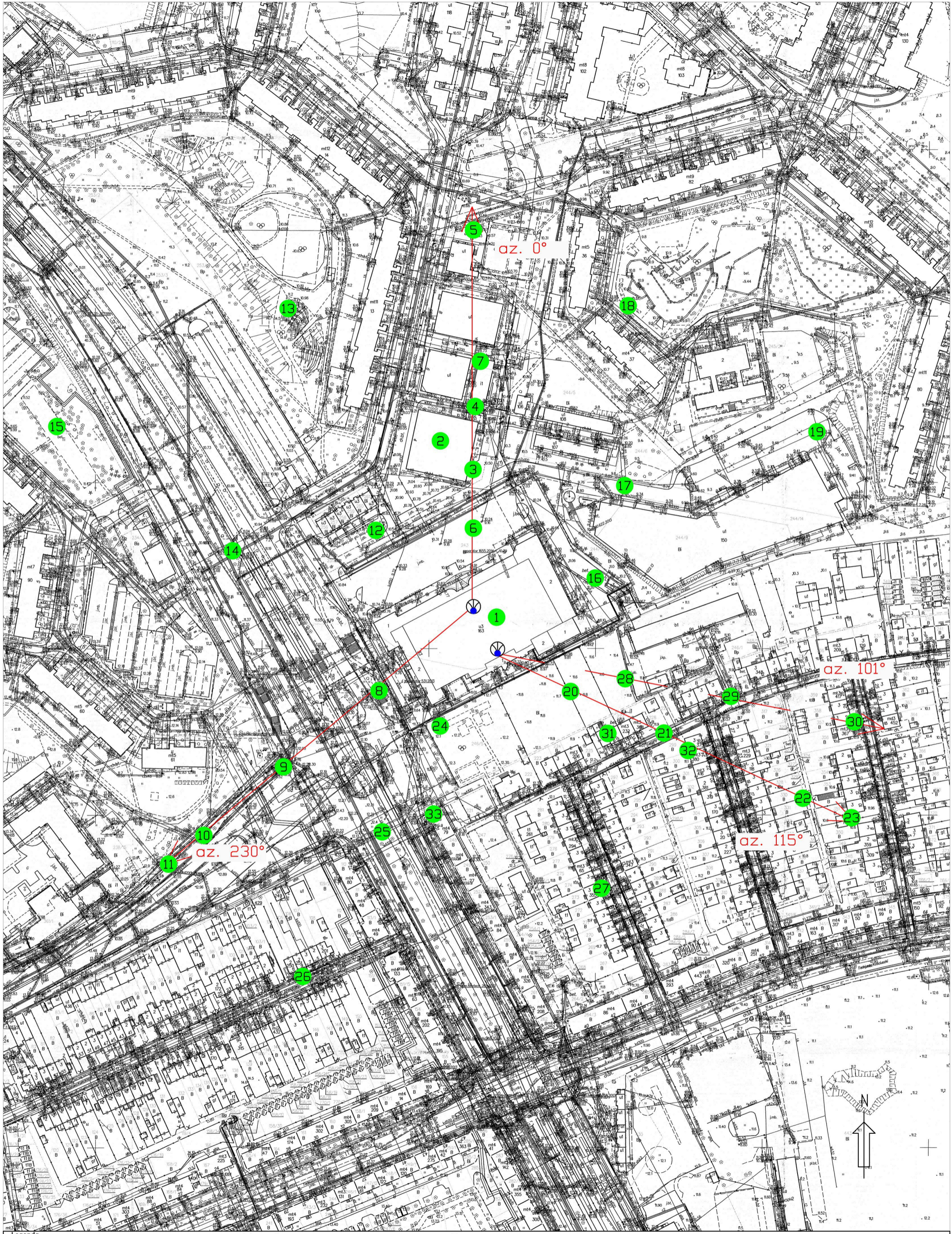
Rys.1 Lokalizacja pionów pomiarowych
