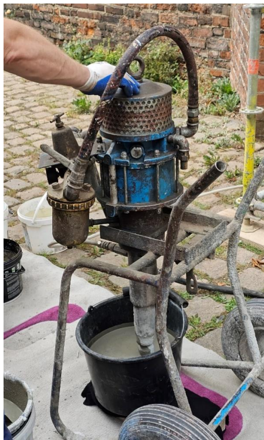
Ilustracja 72. Ciśnieniowa iniekcja zaprawy mineralnej
