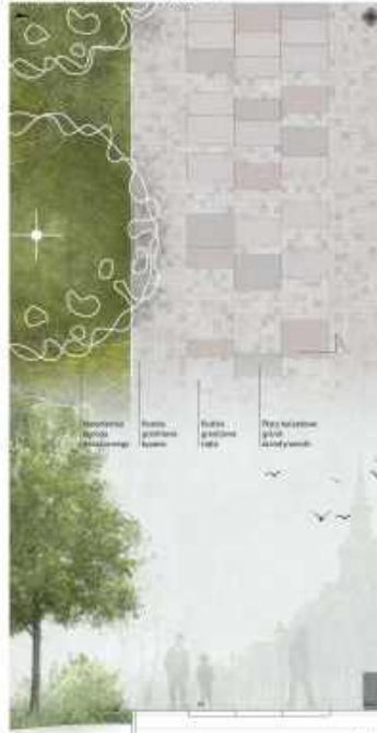
DETAL POSADZEI - PŁYTY GRANITOWE 1:50
