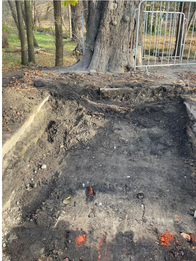
Fot. 7 Wzdłużny układ korzeni względem krawędzi drogi. Brak korzeni w głębi drogi.
