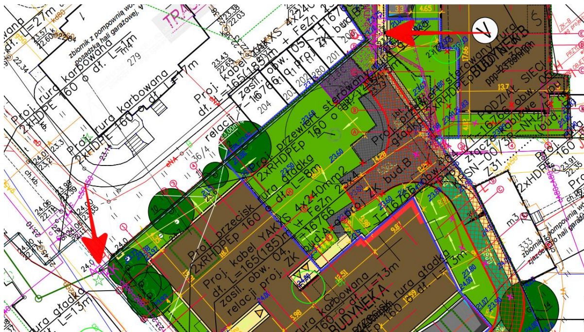
Ryc. 3. Lokalizacja komór startowej oraz końcowej przewiertu sterowanego
