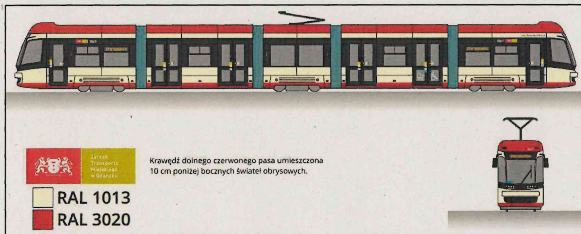
Rys. 2.1. Schemat malowania w sieci Organizatora
