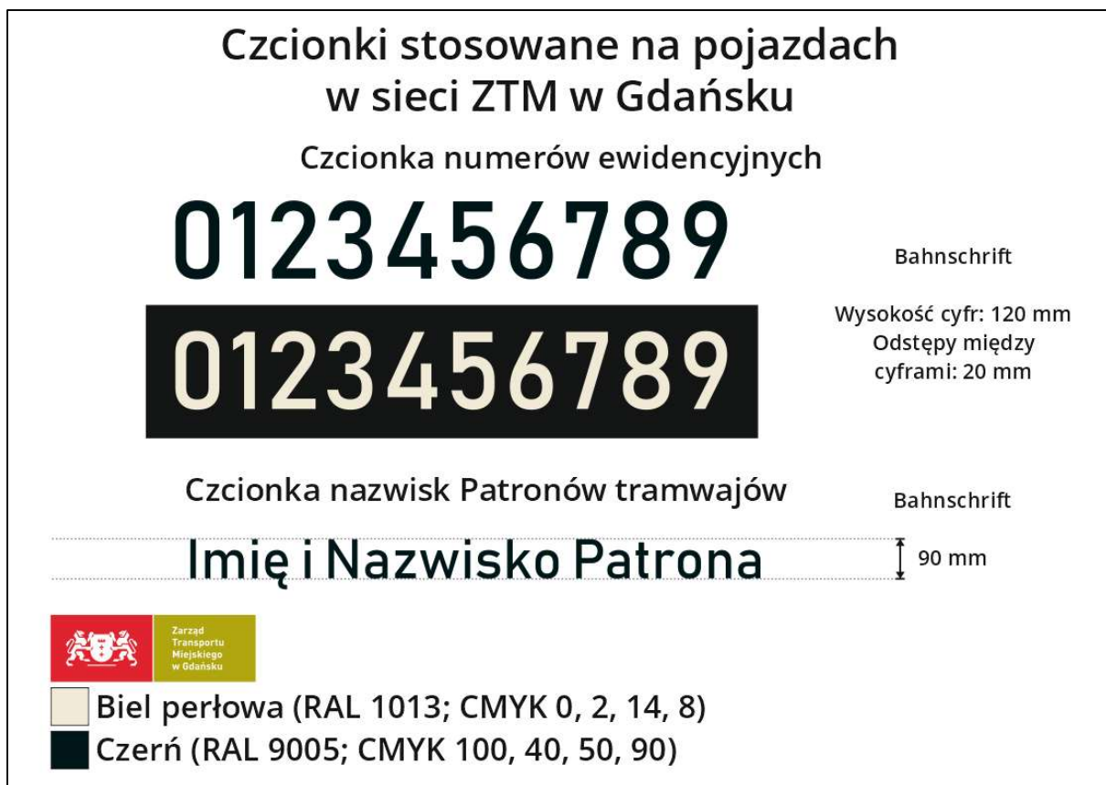
Rys. 3.1. Czcionka numerów ewidencyjnych oraz nazwisk Patronów tramwajów stosowana na pojazdach w sieci Organizatora
