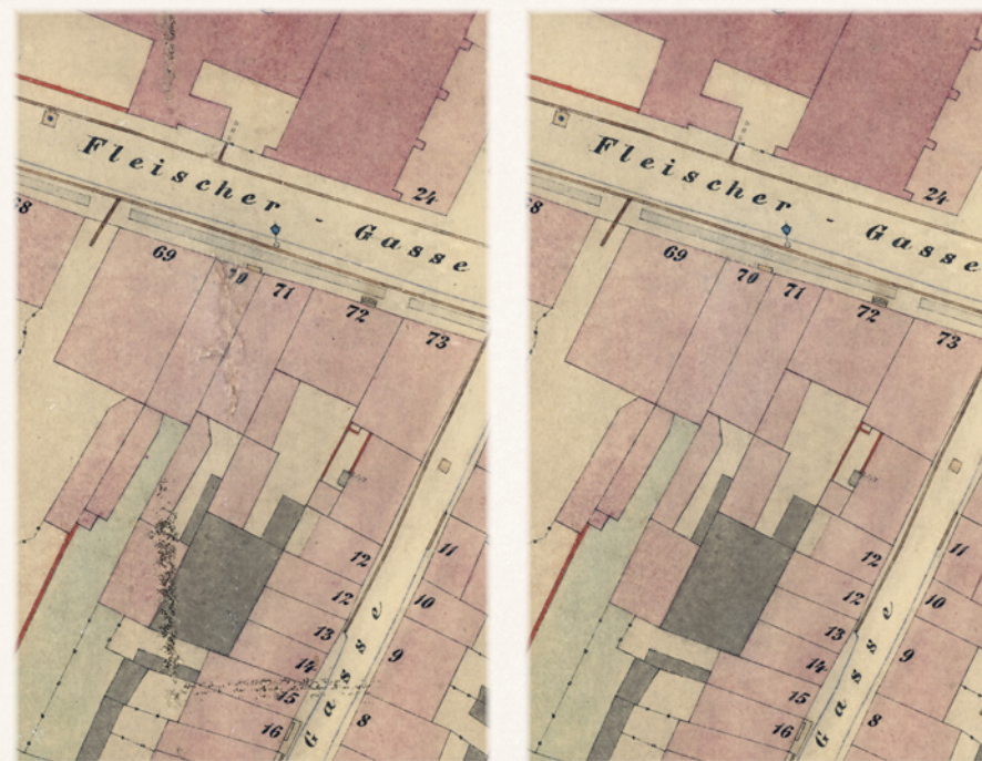
19 Fragment sekcji 6 przed i po etapie czyszczenia zabrudzeń i śladów uszkodzeń. Fragment of Section 6 before and after the stage of cleaning dirt and traces of damage.
