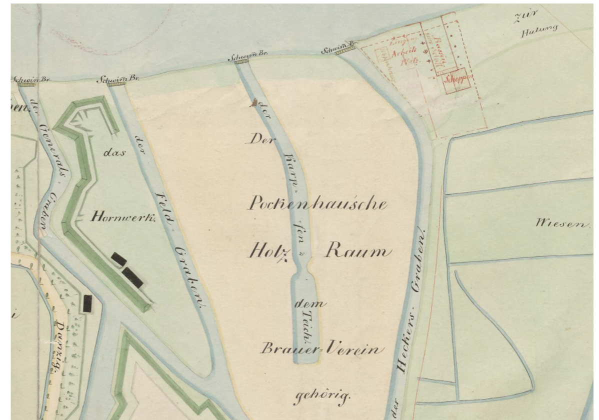
II. 112. Fragment planu przedstawiającego obszar Młodemiejskich Składow DREWNA (II. 111). Na plan naniesiono projektowaną lokalizację bazy remontu korwet (na czerwono). Zaznaczono miejsca na plac roboczy (Arbeits Platz), basen stoczniowy (Bassin), składy – szopy (Schoppen) i budynek mieszkalny, zapewne dla personelu lub straży (Wohnhaus). Widoczne także: kanał - Rów Generalski (Generals Graben, po lewej, dziś nie istniejący) oraz Karpi Staw (Karpfen Teich, pośrodku, także nieistniejący), 1842, zbiory APG
