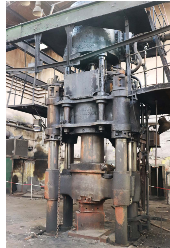
II. 138. Prasa hydrauliczna firmy Breuer, Schumacher & Co. Köln-Kalk w hali 36A, fot. A. Otrębski (CC BY-SA 4.0)
