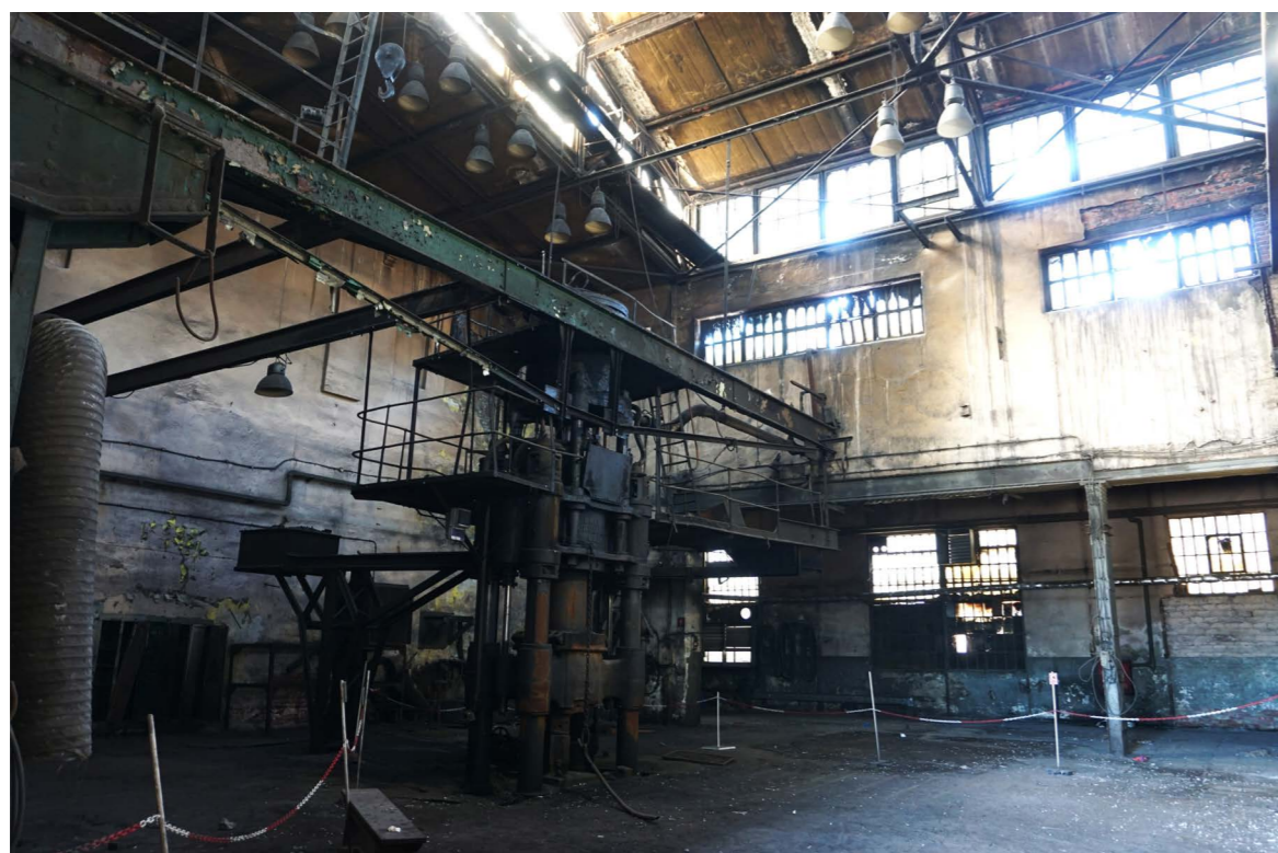
II. 127. Wnętrze kuźni Stoczni Cesarskiej (hala 36A) po 2015 ogołocone z całego wyposażenia za wyjątkiem największej prasy kuzniczej o nacisku 5 000 ton, fot. W. Chmielewski, 2023, zbiory BAM
