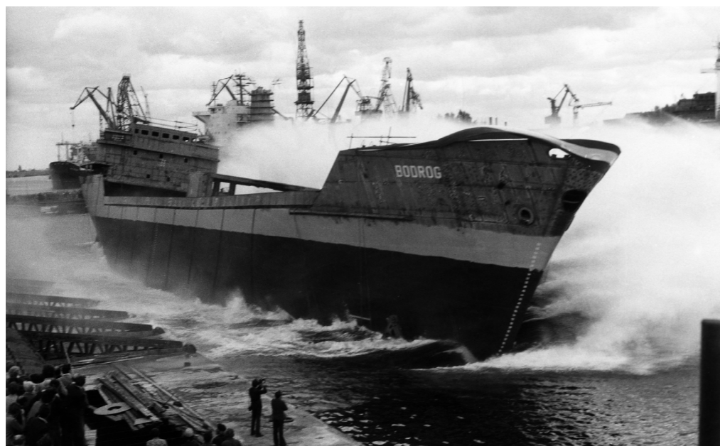
II. 232 Wodowani na pochylni bocznej Wydziału Montażu Kadłubów C1 Stoczni Gdańskiej prototypowego statku drobnicowca Bodrog, zbudowanego dla Węgierskiej Republiki Ludowej, , fot. J. Uklejewski, 1977, archiwum ECS
