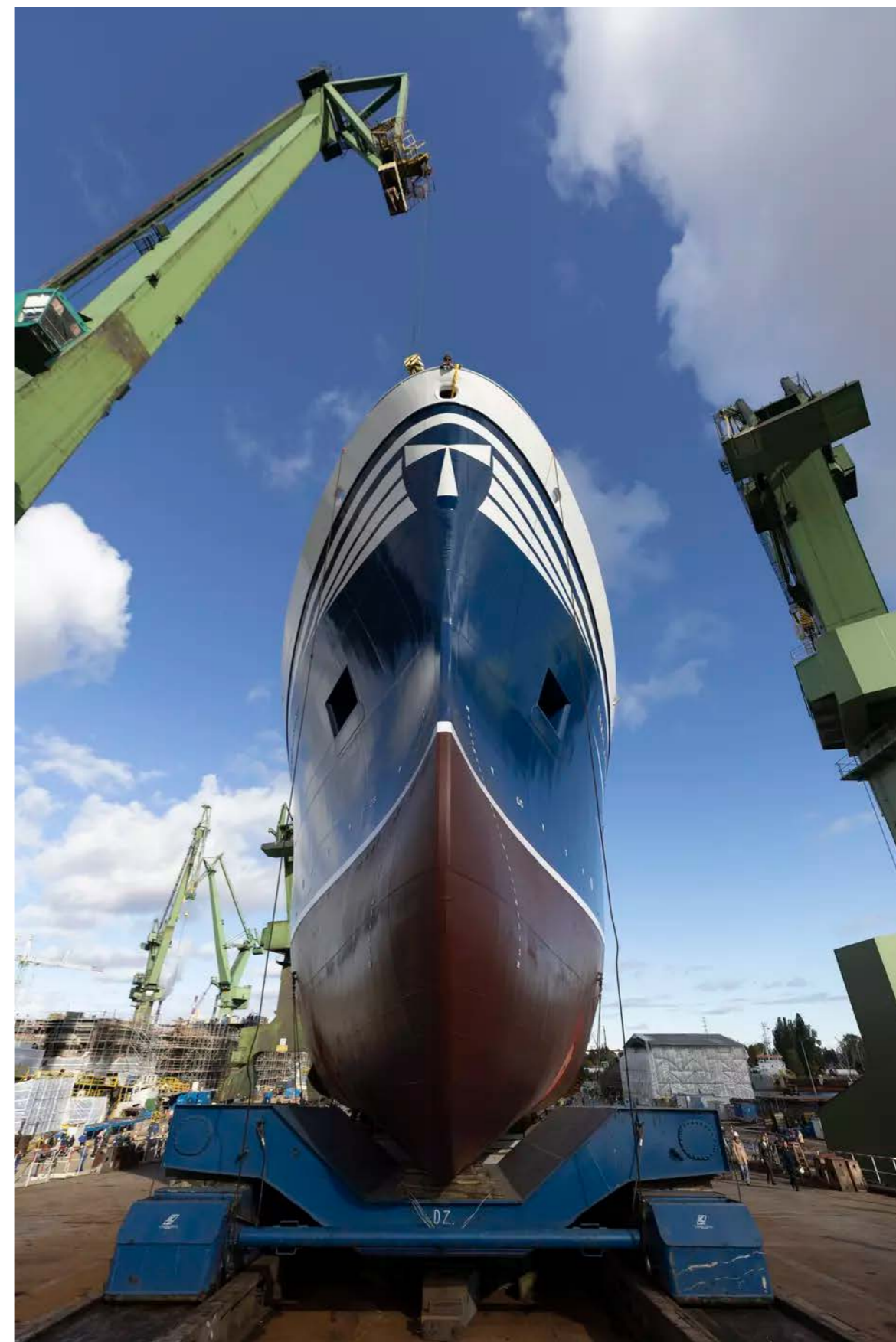
II. 101. Trawler rybacki dla szkockiego armatora przygotowany do wodowania w stoczni Karstensen 14 października 2025 r. Statek stoi na jednej z historycznych pochylni Stoczni Schichaua, w otoczeniu dźwigów Kone pochodzących z okresu modernizacji Stoczni Gdańskiej im. Lenina w latach 70. XX w., fot. G. Mehring, źródło: gdansk.pl
