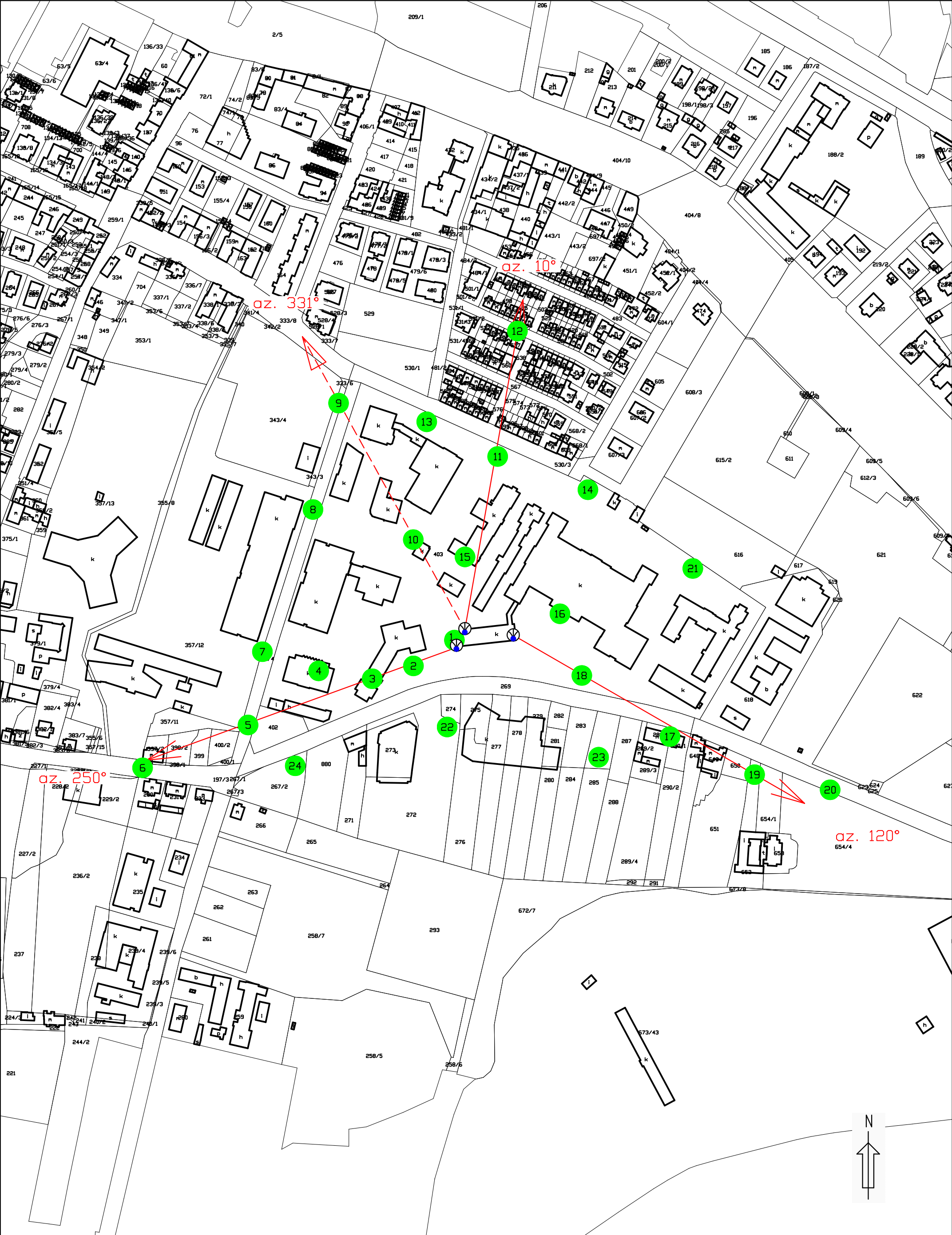
Rys.1 Lokalizacja pionów pomiarowych
