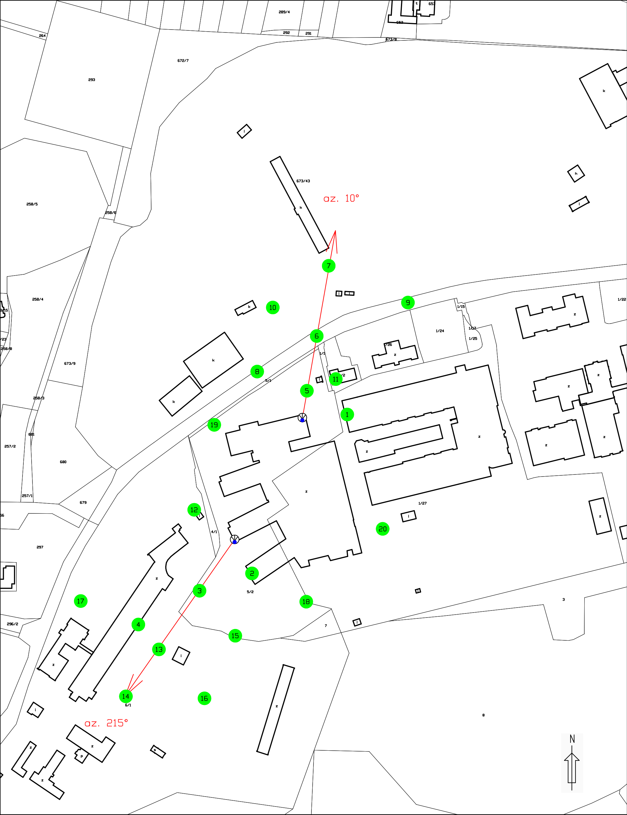
Rys.1 Lokalizacja pionów pomiarowych
