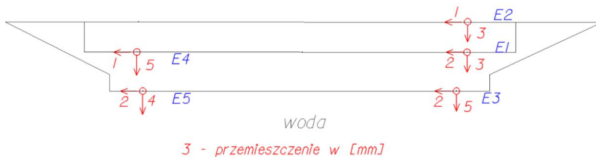
Rys. 7.6 Całkowite przemieszczenia pomierzone od 28.11.2019 na przyczółku wschodnim (Stogi)
