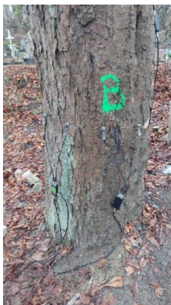
Fot. Wykonywanie tomografii dźwiękowej
