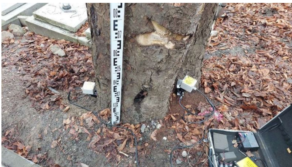
Fot. Wykonywanie testu obciążeniowego – rozmieszczenie inklinometrów
