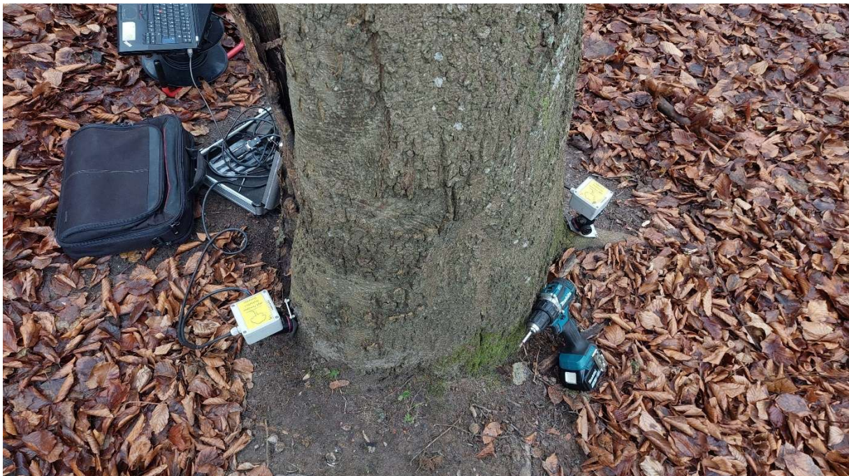
Fot. Wykonywanie testu obciążeniowego – rozmieszczenie inklinometrów
