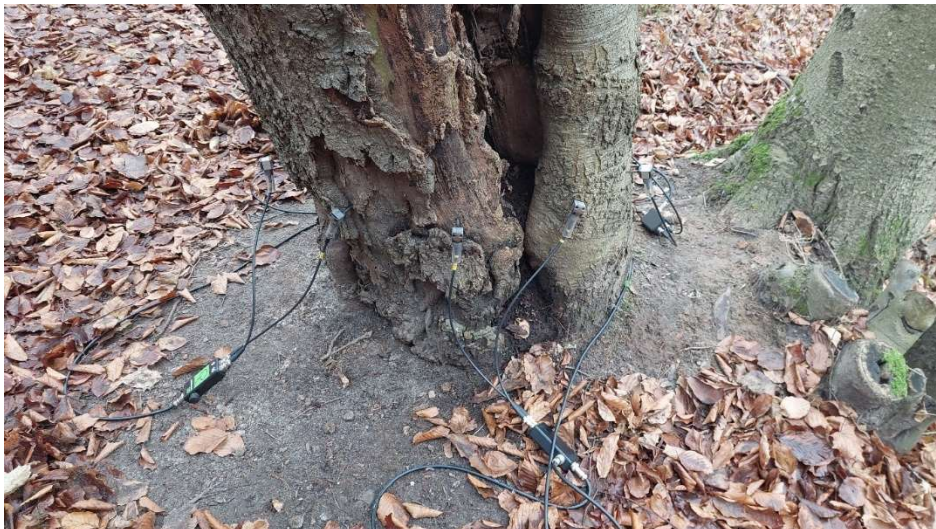
Fot. Wykonywanie tomografii dźwiękowej
